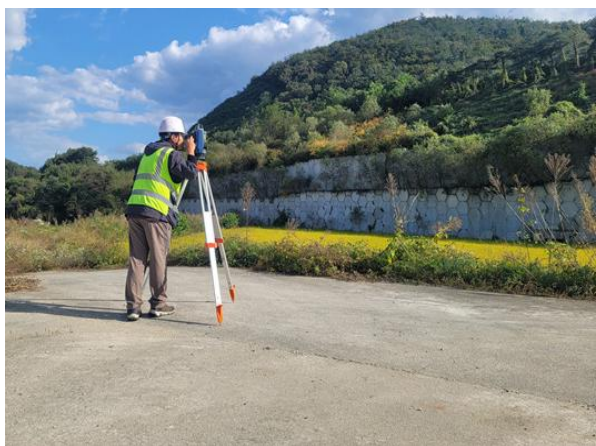
광파기를 이용한 측량 작업
