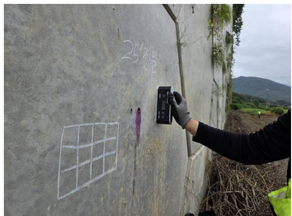
경사계를 이용한 경사도 측정
